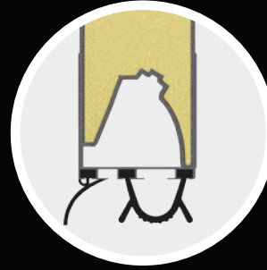
Uszczelka wsuwana w dolny aluminiowy profil
