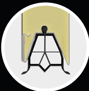
Uszczelka wsuwana w dolny panel
